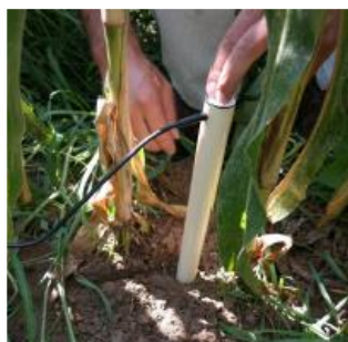
Figura 4.20 – Sonda para controlo da humidade, temperatura e salinidade dos solo
